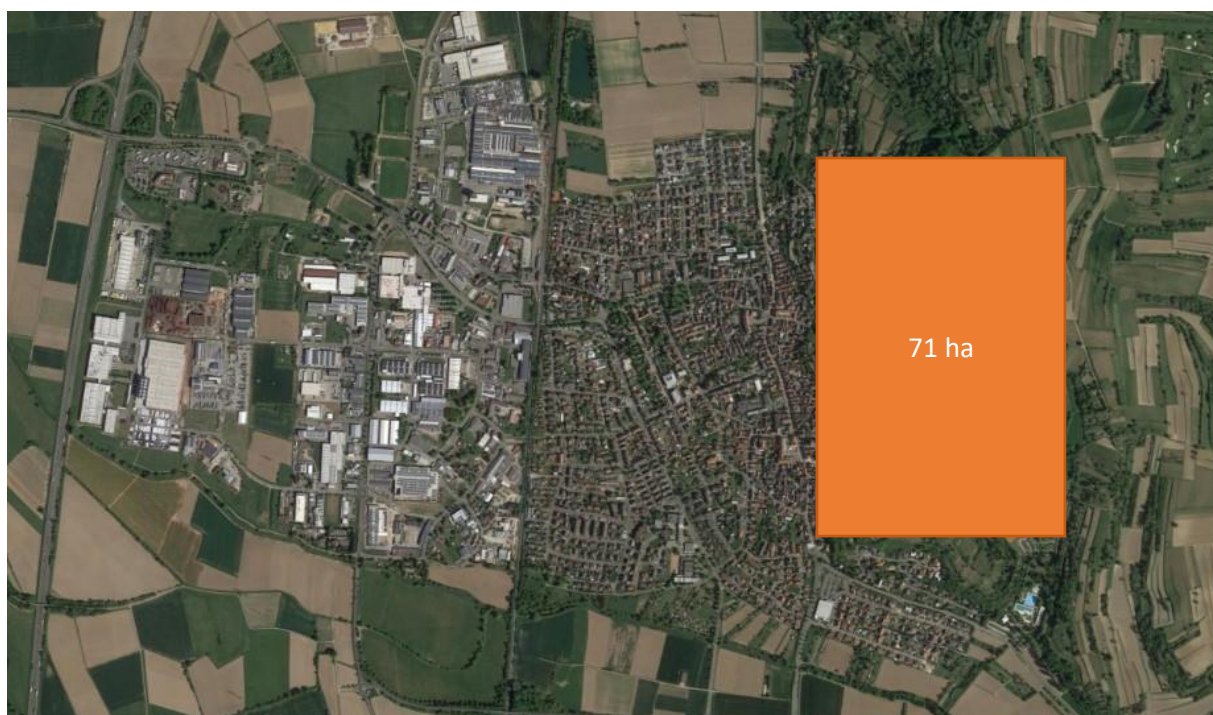
Abbildung 43: Benötigte Fläche für Erdsonden für eine vollständige Wärmeversorgung (bilanziell) von Herbolzheim (Bildquelle: Google Earth)
